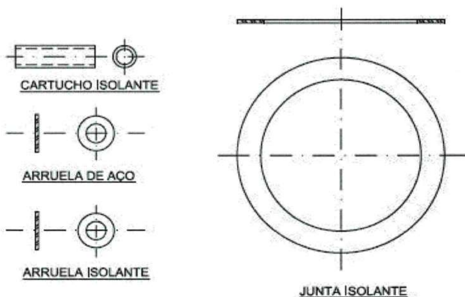
Figura 01 – Instalação de kit completo de junta isolamento em flanges tipo RF.
